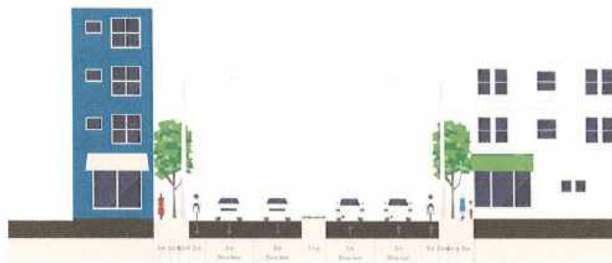
Fig. 24 Stradă cu 4 benzi, separator de sens și trotuar îngust
