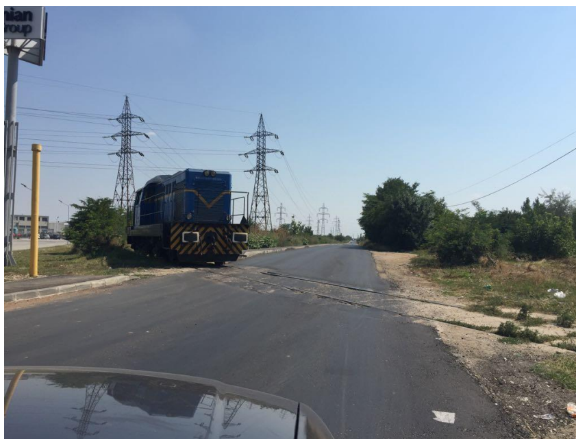
Figura 2.6.2 Trecere la nivel pentru aprovizionare (trecere 1)
